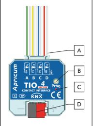
Anschlusskabel der Kanäle A B C D
